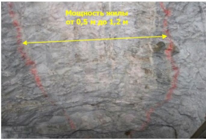
Рис. 5. Разметка жилы на кровле выработки
