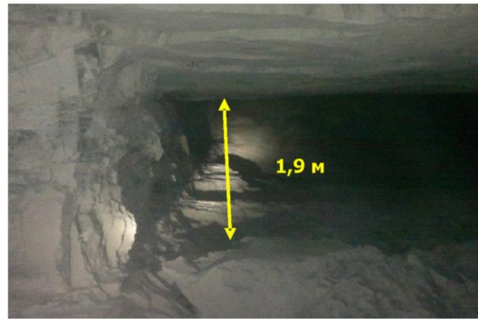
Рис. 7. Натурная съемка очистного пространства с использованием диаметра скважин 57 мм
